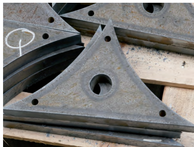
Exemple typique de pièces sur lesquelles la découpe plasma et le perçage se complètent à merveille.
