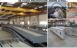
Ce type de profil remplace les poutrelles laminées pour de longues portées. Obtenu par soudage de plats et de tôles, le profil en forme de « I » est reconstitué suivant des besoins spécifiques et permet d'obtenir les inerties appropriées.
